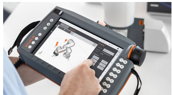
그림 1. 독일 KUKA사의 협동 로봇을 위한 보편적인 티칭 펜던트 Fig. 1. Conventional teaching pendant for Germany KUKA's collaborative robots.
